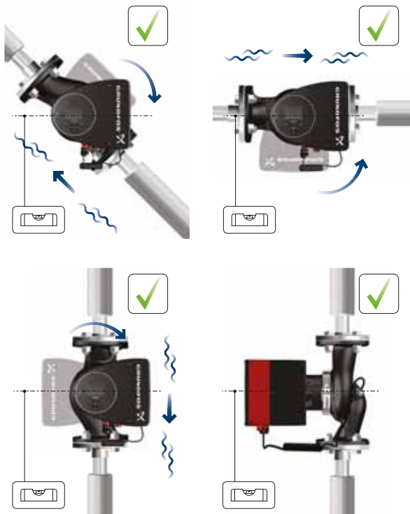
Fig. 7 Bomba con la caja de control en posición horizontal
