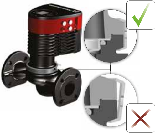
Fig. 11 Instalación del cabezal de la bomba en la carcasa de la bomba
